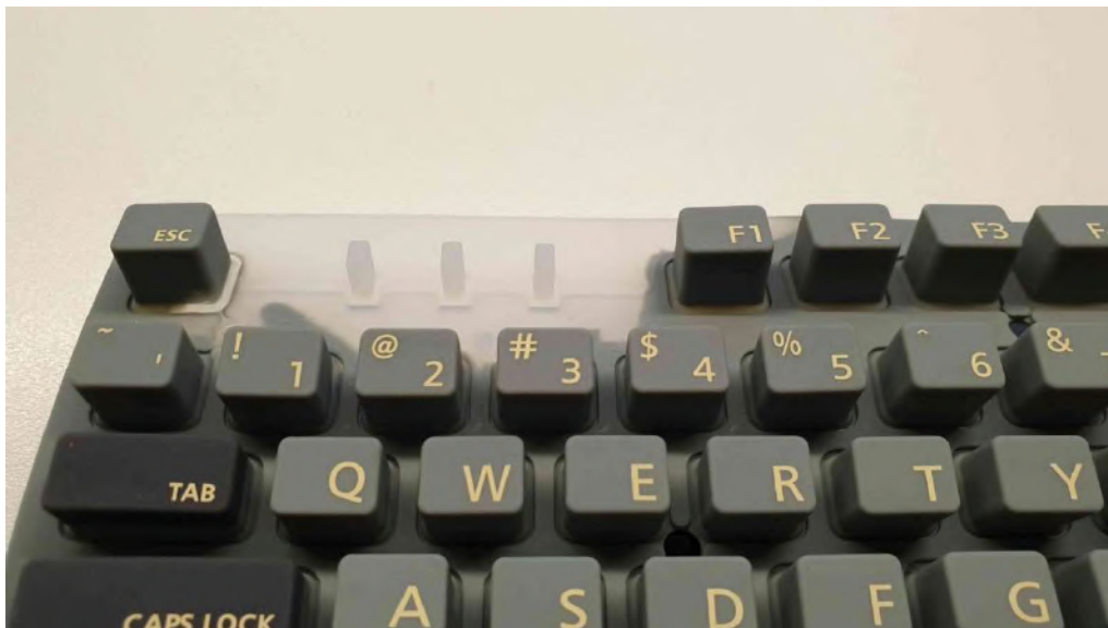
Figura 40 – spie sporgenti di una tastiera in silicone co-stampato con inserto trasparente
