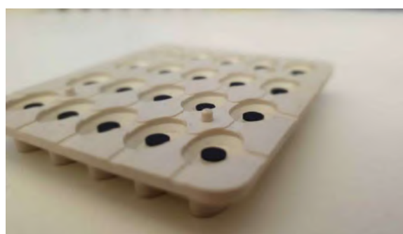
Figura 8 – torretta di centraggio
