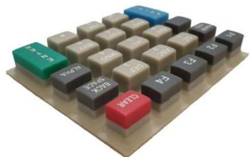
Figura 17 – esempi di stampaggio con inserti di silicone colorati
