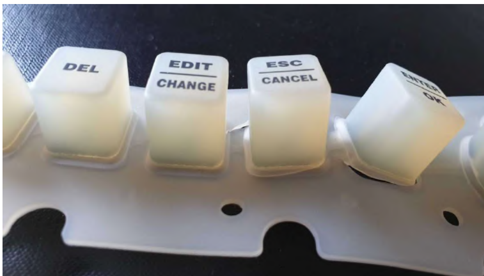
Figura 25 – tastiera invecchiata, con il collare di alcuni tasti lacerato
