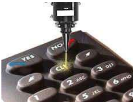
Figura 32 – incisione con laser (laser etching)
