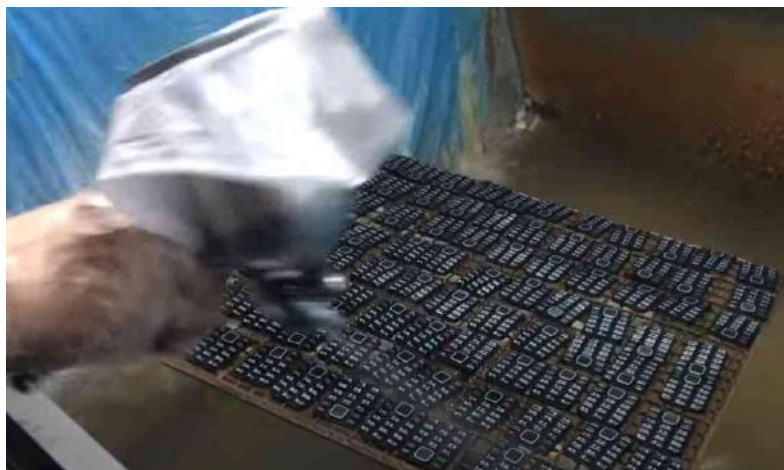
Figura 42 – trattamento PU coating con pistola a spruzzo su più tastierini
