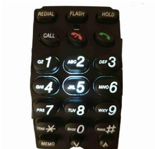
Figura 39 – tastiera retro-illuminata con legende realizzate con la tecnica del laser etching
